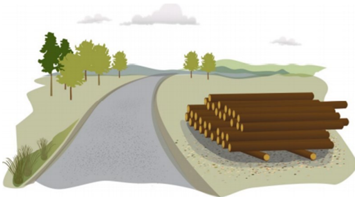
Joonis 4 Virna selline ülesehitus takistab palgitõstke tungimist auto sõitjate ruumi, kui see on teelt välja vastu virna sõitnud
